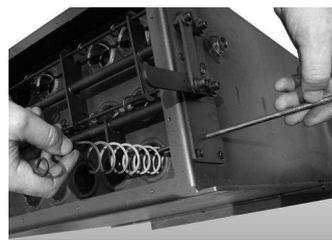
Ora la sezione superiore allo scambiatore di calore è sgombra da qualsiasi ingombro in modo da permettere una perfetta pulizia.
