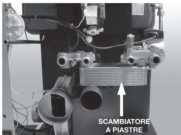
Il kit già premontato dalla casa produttrice ha il compito di riscaldare l'acqua sanitaria proveniente dalla linea idrica dell'abitazione. Nel momento in cui c'è richiesta di acqua calda aprendo un rubinetto, il flussostato comanda alla valvola deviatrice di convogliare l'acqua calda contenuta all'interno della termostufa verso lo scambiatore a piastre.
