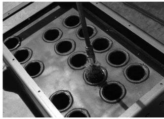
È possibile effettuare la pulizia dopo aver tolto le molle inserite in ogni tubazione. L'operazione è semplice sfilando le molle dal perno orizzontale a cui sono fissate.
