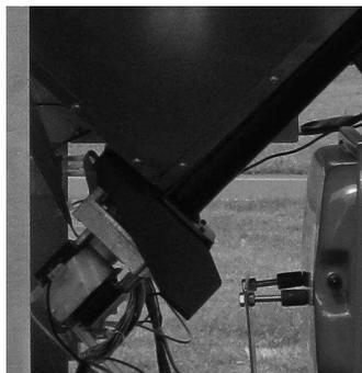
**Motoriduttore:** se il motoriduttore si ferma, la stufa continua a funzionare fino a quando non si spegne la fiamma per mancanza di combustibile e fino a che non raggiunge il livello minimo di raffreddamento.
