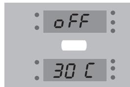
La caduta dei pellets si fermerà subito mentre la termostufa continuerà a funzionare fino al completo smaltimento del calore accumulato, spegnendosi **dopo un massimo di 30 minuti**.
