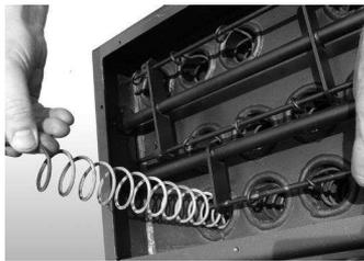
Per eseguire l'operazione, il perno orizzontale può essere sfilato attraverso un foro posto sulla parete del corpo stufa.
