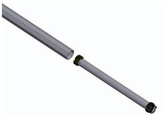
La lunghezza dell'ottagono deve essere tale che, si abbia la lunghezza complessiva ( L ) come indicata in figura sottostante, ricordandosi di lasciare un piccolo gioco di 2-3 mm. Per la verifica posizionare, temporaneamente, la staffa a muro nella posizione indicata, che simula la condizione di montaggio finale.
