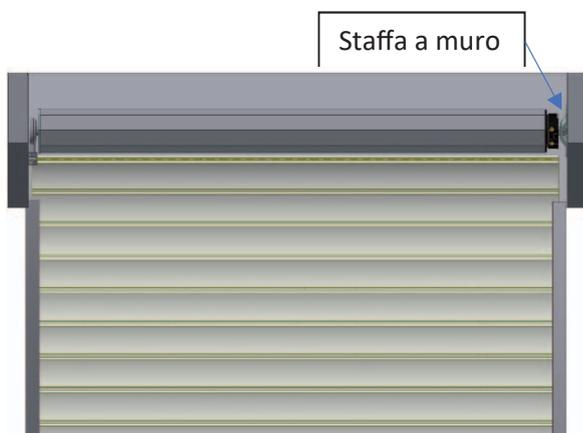
Presentare la motorizzazione assemblata, rispettando l'allineamento tra i due supporti estremi e verificando con la livella che il tubo ottagonale sia in bolla. Tracciare la posizione dei fori della staffa a muro in maniera tale da avere le due viti regolazione in una posizione facilmente accessibile. Fissare la staffa a muro.
