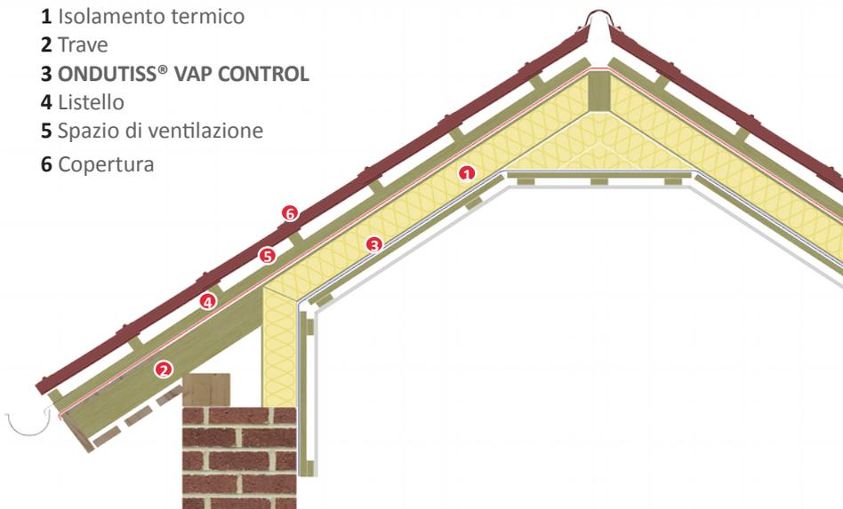
Srotolare **ONDUTISS® VAP CONTROL** partendo dal basso e parallelamente alla linea di gronda, con la scritta rivolta sempre verso l'alto. La membrana può essere posata direttamente sotto l'isolamento termico. La sovrapposizione corretta è indicata da linee o dalla stampa del logo. Per una migliore tenuta all'acqua sigillare le sormonte di **ONDUTISS® VAP CONTROL** con il nastro adesivo **ONDUTISS® UNO**.
