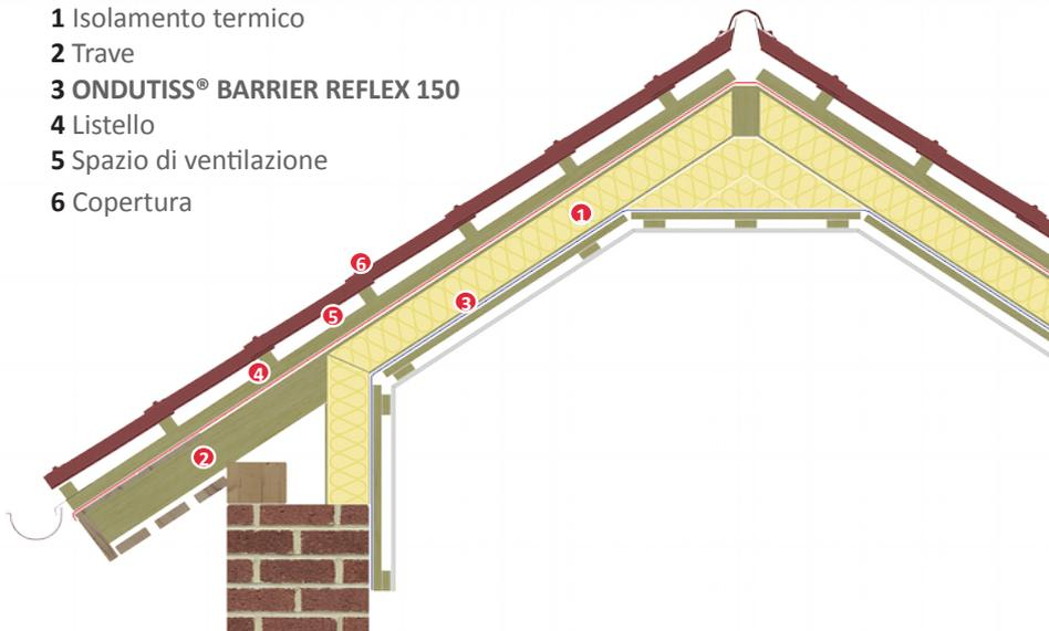
Srotolare **ONDUTISS® BARRIER REFLEX 150** partendo dal basso e parallelamente alla linea di gronda, con la scritta rivolta sempre verso l'alto. Lo schermo può essere posato direttamente sotto l'isolamento termico. La sovrapposizione corretta è indicata da linee o dalla stampa del logo. Per una migliore tenuta all'acqua sigillare le sormonte di **ONDUTISS® BARRIER REFLEX** con il nastro adesivo **ONDUTISS® TAPE REFLEX**.
