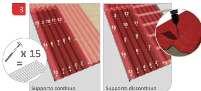
Fissare ogni singola lastra con minimo 15 fissaggi. Il fissaggio va eseguito sempre nella parte alta delle onde, seguendo la corretta sequenza riportata in figura.
