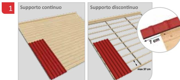
Iniziare a posare le lastre a partire dalla linea di gronda con una sporgenza massima di 7 cm. L'installazione può essere realizzata sia su un supporto di legno continuo (consigliato) sia su supporto discontinuo (interasse fra gli appoggi: max 37 cm).
