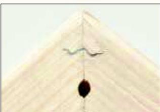
Punti metallici in acciaio inox utilizzati oltre alla spina in legno e alla colla.
