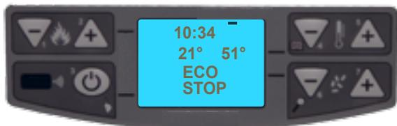
Terminata la fase di spegnimento, il display visualizza la scritta ECO STOP. La termostufa rimane in questo stato finché la temperatura scende a 18°C, solo allora viene riavviata la fase di accensione.
