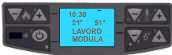
Viene attivata la fase di modulazione, in quanto è stata raggiunta la temperatura del set ambiente. Se la temperatura viene mantenuta per circa un paio di minuti la termostufa si spegne.
