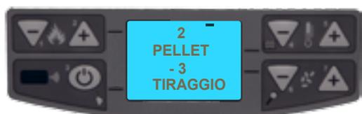
Con i tasti P6 e P7 viene modificato il valore del tiraggio, con i tasti P4 e P5 si può dosare la quantità di pellet utilizzata (il valore indicato durante la modifica segnala solamente un valore percentuale che agisce sui parametri di default impostati nella scheda elettronica).
