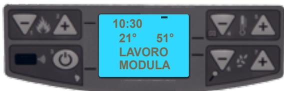
Viene attivata la fase di modulazione, in quanto è stata raggiunta la temperatura del set acqua. Se la temperatura raggiunge "set-acqua"+ "delta-comfort clima" e si mantiene per circa un paio di minuti la termostufa si spegne.
