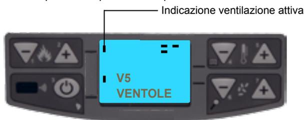
2. Modificare la velocità della ventilazione con i tasti P4 e P5.
