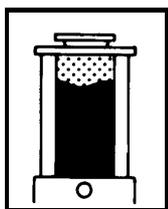
Riscaldamento insufficiente della parte superiore del bruciatore. Controllare la qualità del combustibile
