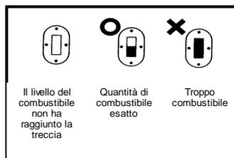
Dopo aver riempito il serbatoio riavvitare bene il tappo dello stesso ed eliminare con cura qualunque traccia di combustibile liquido per stufe portatili. Rovesciare il serbatoio. Afferrarlo per la maniglia e riposizionarlo delicatamente al proprio posto.
