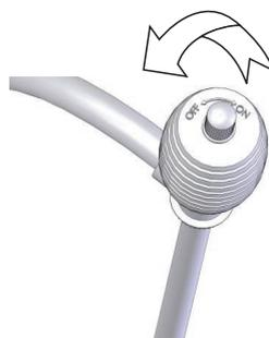
Finito di riempire il serbatoio della stufa, posizionare la manopola sulla posizione off, ruotando la stessa in senso antiorario. In questo modo si svuota la pompa a sifone.
