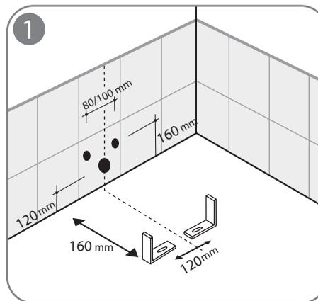
1 - Preparare il tubo di scarico e gli scarichi e posizionare le viti di fissaggio mantenendo la distanza mostrata nella figura 1.
