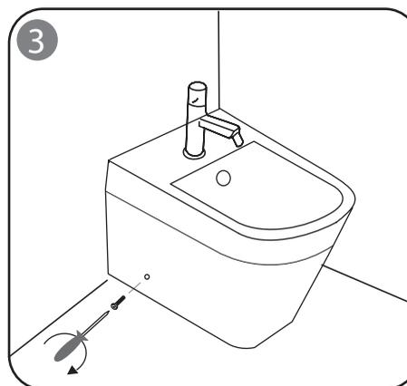
3 - Livellare il bidet e fissarlo utilizzando le apposite viti. Al fine di ottenere una installazione corretta alla parete, si consiglia di alternare l'avvitamento.
