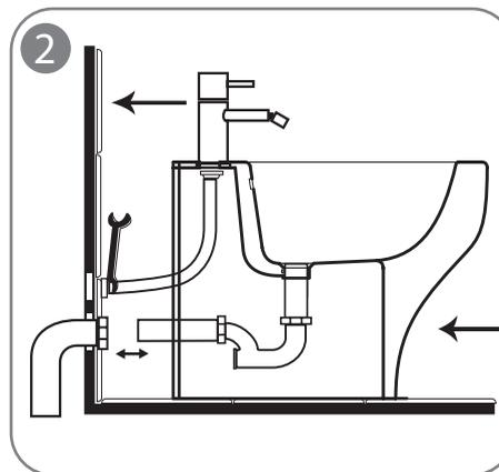
2 - Installare la rubinetteria ed il sifone lasciando che il tubo di scarico esca dal bidet a sufficienza per permettere allo scarico di essere fissato a muro. Collegare i due tubi flessibili dell'acqua e lo scarico alle prese del muro.
