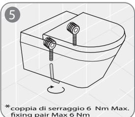
5 - Fissare il vaso sospeso mediante i dadi di fissaggio. Si consiglia di avvitare alternativamente i dadi in modo da ottenere un fissaggio migliore del vaso alla parete.
