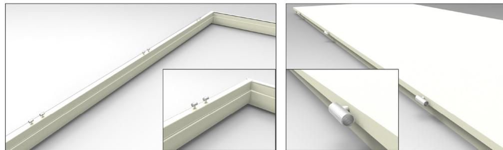
**G** E' consigliato montare il telaio porta su piano orizzontale (eventualmente rivestito di materiale idoneo affinché non si danneggi la finitura della porta). Assemblare il telaio inserendo gli appositi spinotti in legno nelle sedi preforate agli angoli e successivamente fissare la struttura in modo rigido con le apposite viti fornite 4x60mm.
