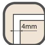
Correggere la posizione del montante stipite nel punto della vite n°4, in modo che a porta chiusa (lato serratura), il gioco luce tra anta e montante stipite in battuta sia uniforme in tutta la sua lunghezza e di circa 4mm.
