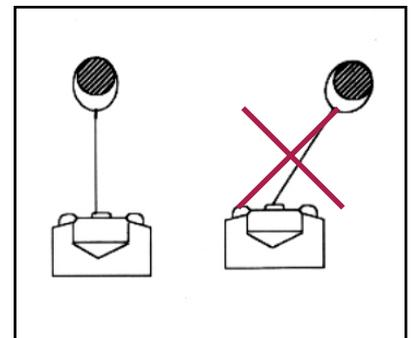
Figura 20 – Trazione del carico.
