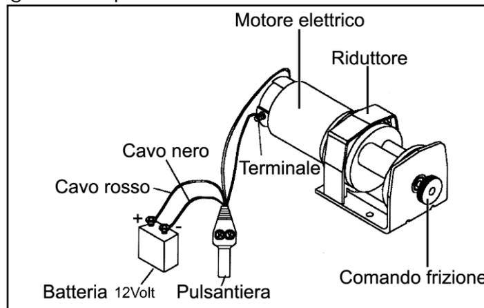
Figura 10 – Collegamento della batteria e dell'argano.
