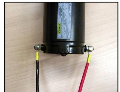
Figura 11 – Collegamento dell'argano.
