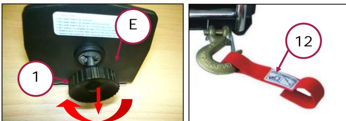
Figura 18 – Pomello di sblocco del tamburo / nastro.
