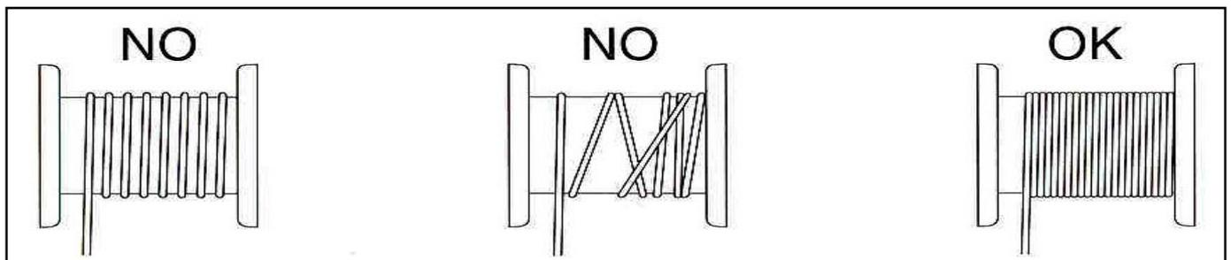
Figura 17 – Avvolgimento del cavo sul tamburo.
