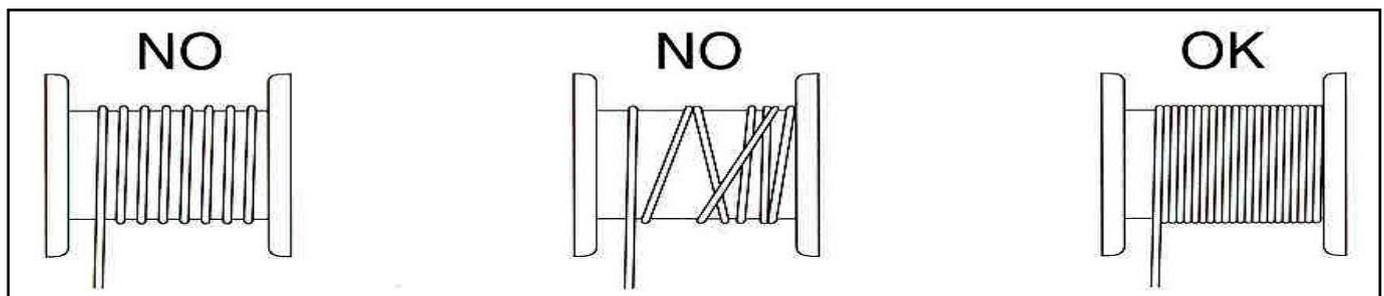
Figura 24 – Avvolgimento del cavo sul tamburo.
