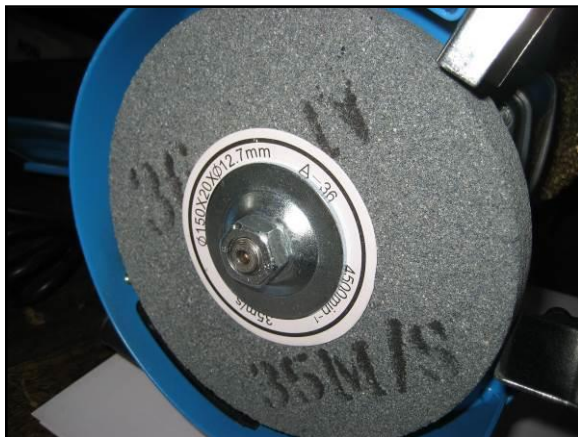
Figura 15 – Dado e flangia di fissaggio della mola.
