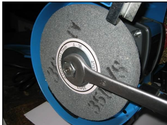
Figura 15 – Dado e flangia di fissaggio della mola.
