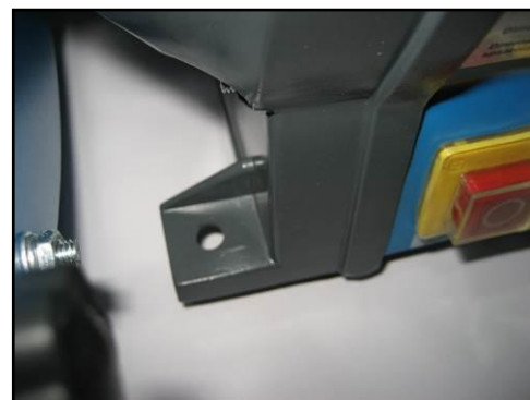
Figura 4 – Dettaglio foro di fissaggio
