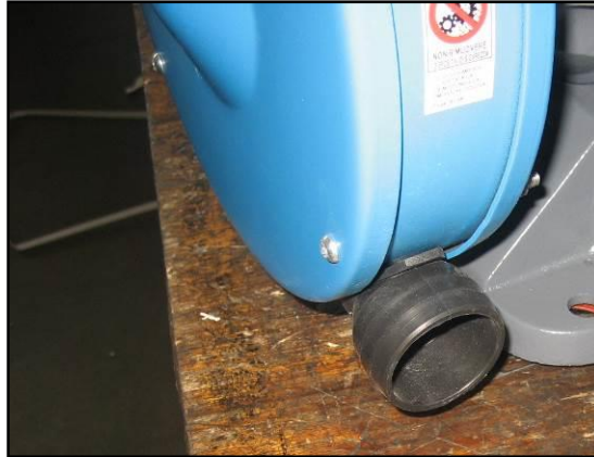
Figura 5 – Presa per il sistema di aspirazione sul riparo.
