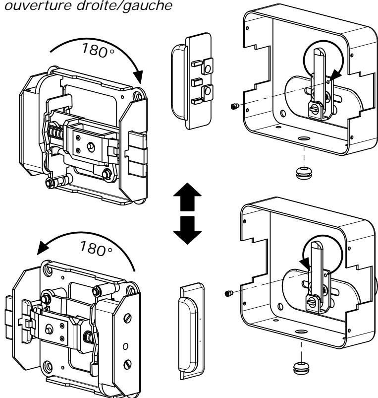
montaggio cilindro staccato - installing the loose cylinder -
