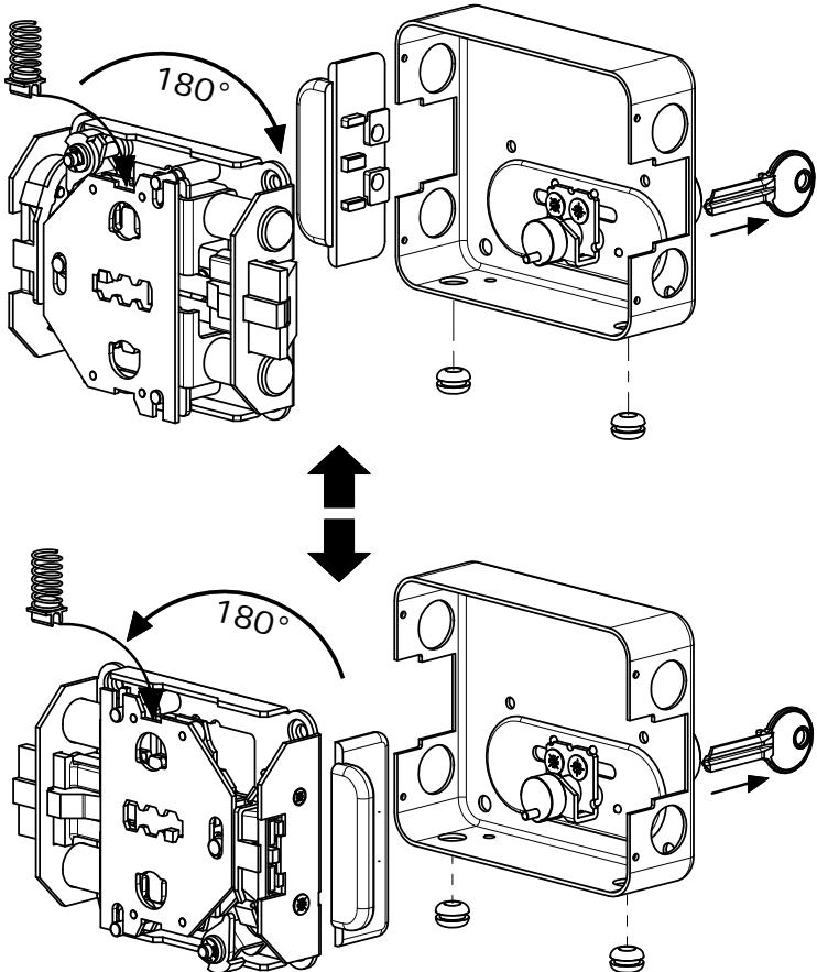
montaggio cilindro staccato - installing the loose cylinder -
