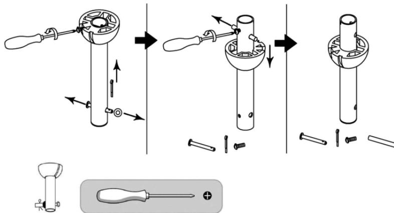
4. Assemblare l'asta rivolta verso il basso con l'alloggiamento del motore e il tappo superiore.
