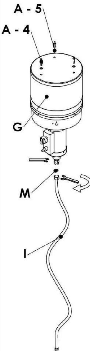
**Attenzione:** verificare la presenza della guarnizione **M** tra il tubo flessibile del gas ed il bruciatore.
