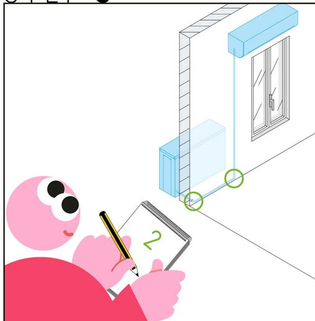
Verifica che il **numero di curve** necessarie per collegare unità interna e unità esterna **non sia superiore a 2**.
