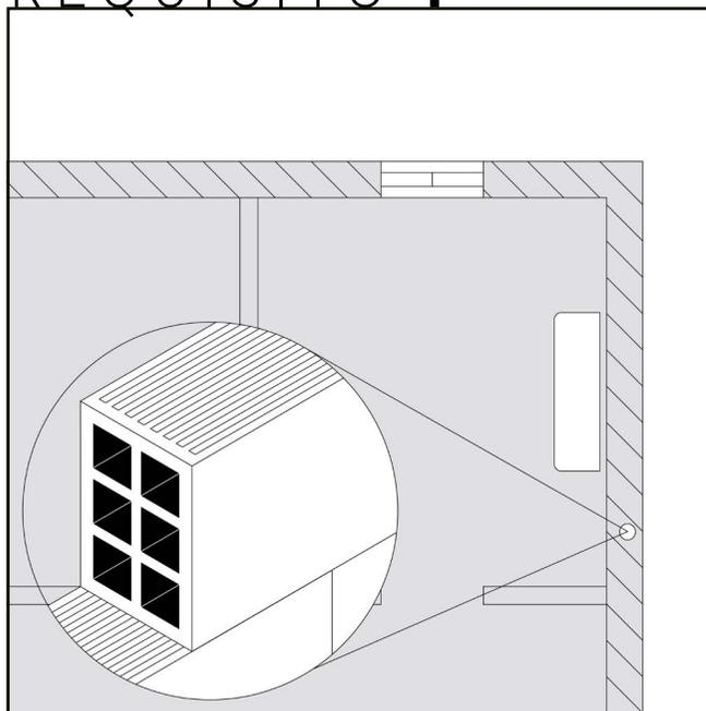
Se l'impianto non è da effettuare, l'unità interna deve essere installata su un **muro perimetrale** in mattone forato.
