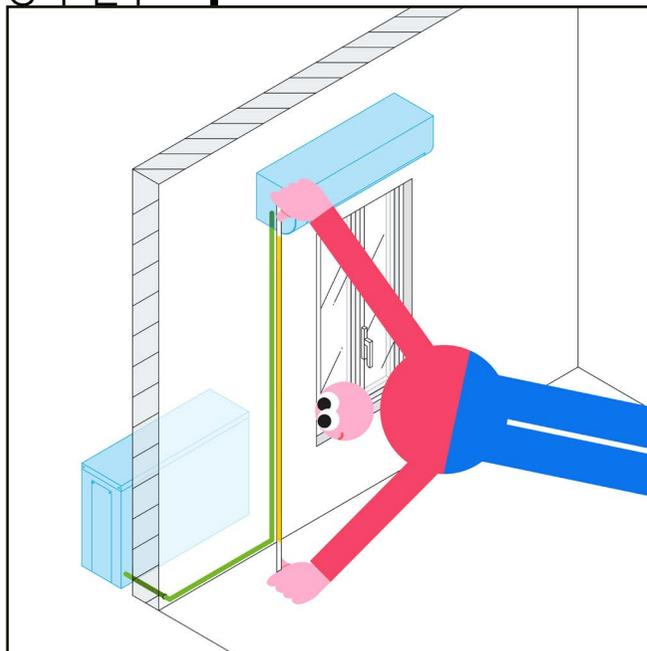
Misura il percorso dei cavi di collegamento tra l'**unità esterna** e l'**unità interna**, non la distanza in linea d'aria. Verifica che **non sia superiore a 4 metri**.
