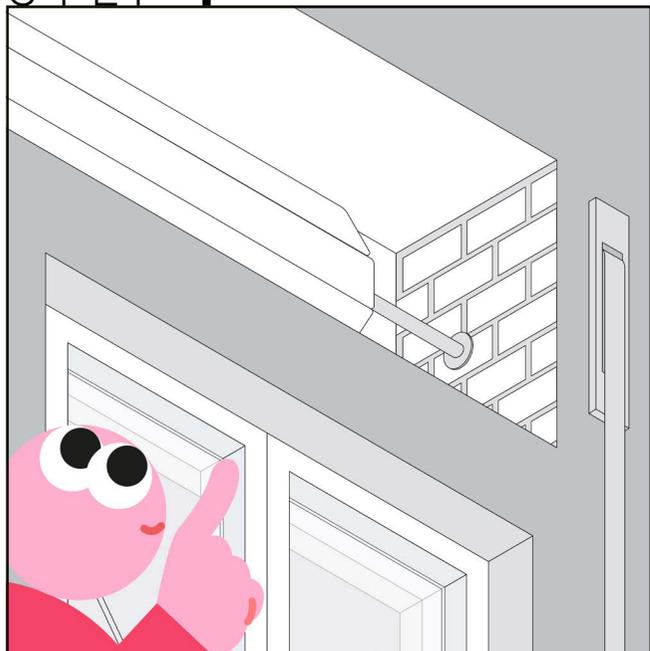
Controlla la **tipologia di muro** (tufo o mattone forato o altro). Puoi capirlo guardando all'interno dei **cassonetti delle tapparelle**.
