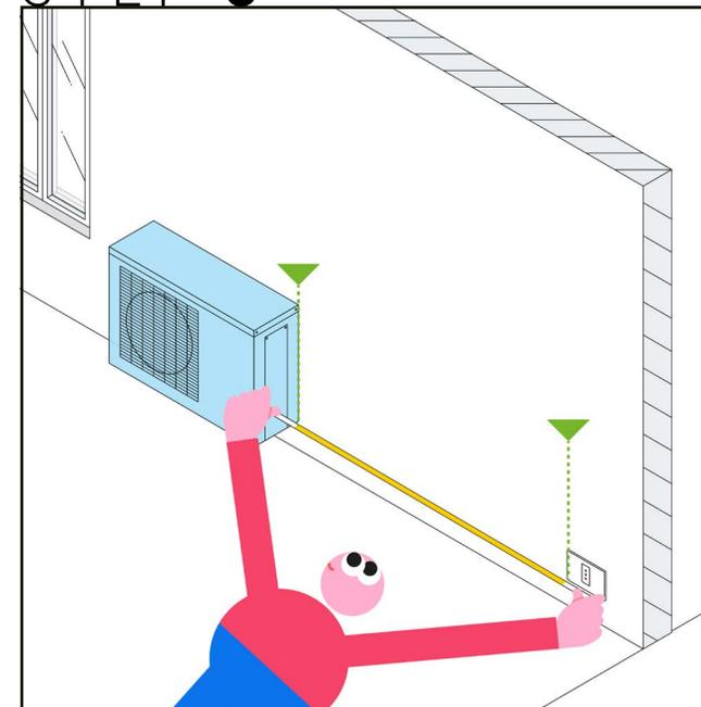
Misura la distanza tra l'**unità esterna** e la **presa elettrica** più vicina. Verifica che **non sia superiore a 1,50 metri**.
