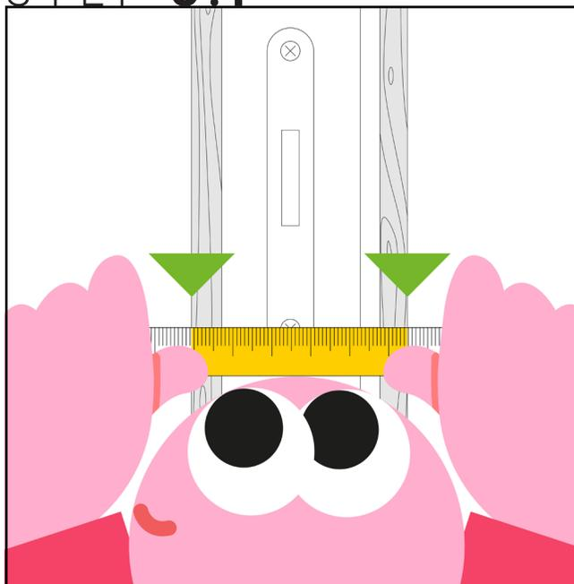
Da esterno a esterno del **controtelaio** in legno. Se non vedi il controtelaio, rileva la misura del telaio.
