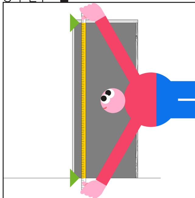
Misura l'**altezza netta del vano passaggio**: come prima, corrisponde alla distanza tra la traversa in metallo e il pavimento finito.
