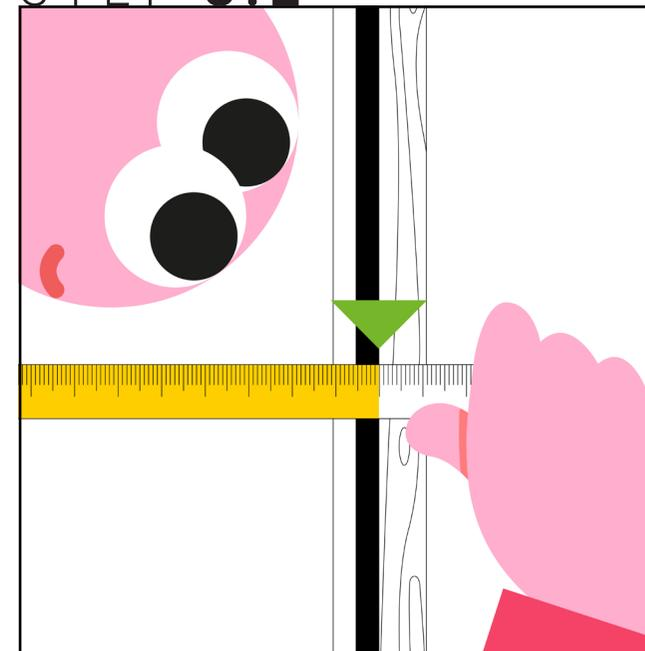
Fino allo **spigolo interno** del controtelaio in legno.
