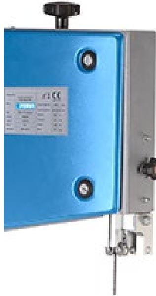
Figura 16 – Carter regolabile di protezione lama.
