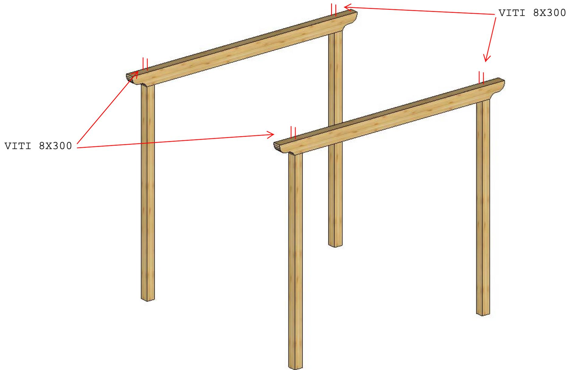
UNA VOLTA VERIFICATO CHE I PILASTRI SIANO STATI INSTALLATI A REGOLA D'ARTE SI PROCEDE POSIZIONANDO I TRAVI DI BANCHINA SEZ. 100 X 160 MM SUI PILASTRI E SI PROCEDE FISSANDOLI CON N° 2 VITI 8 X 300 MM PER PILASTRO. SI CONSIGLIA DI PREFORARE IL TRAVE CON UNA PUNTA DIAM. MM 6.
