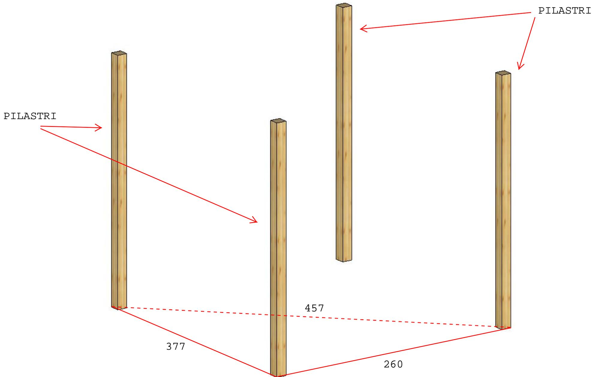
FISSARE I PILASTRI A TERRA MEDIANTE LE STAFFE IDONEE AL TIPO DI SUPERFICIE (STAFFE NON INCLUSE NEL KIT DI MONTAGGIO). VERIFICARE CHE I PILASTRI SIANO IN QUADRO, CHE I LATI SIANO ALLA GIUSTA DISTANZA E CHE LE DIAGONALI SIANO UGUALI. BATTERE I PIANI IN MODO CHE LA COPERTURA SIA INSTALLATA NEL MODO IDONEO. I PILASTRI VENGONO FORNITI 2 DA 240 CM E 2 DA 300 CM NEL CASO IN CUI SI VOGLIA DARE PENDENZA ALLA COPERTURA. VERIFICARE CHE I PILASTRI SIANO A PIOMBO.
