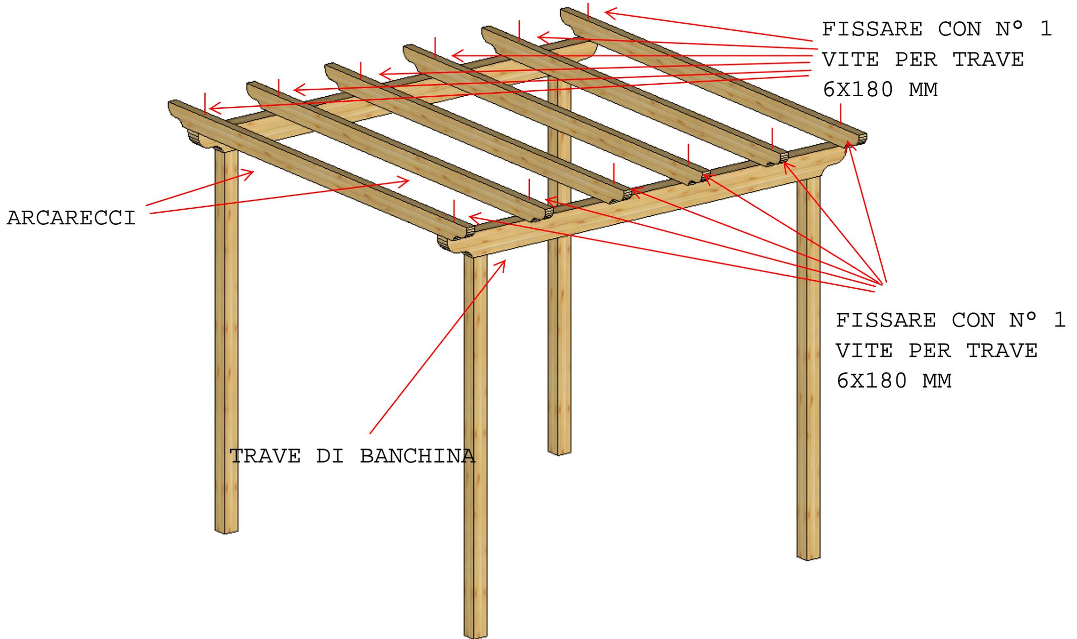
UNA VOLTA VERIFICATE LE SPAZIATURE FRA GLI ARCARECCI, LE SPORGENZE E CHE I PILASTRI SIANO EQUIDISTANTI, FISSARE GLI ARCARECCI AI TRAVI DI BANCHINA SEZ. 60 X 120 MM CON N° 1 VITE 6 X 180 MM. SI CONSIGLIA DI PREFORARE GLI ARCARECCI CON UNA PUNTA DIAM. MM 5.
