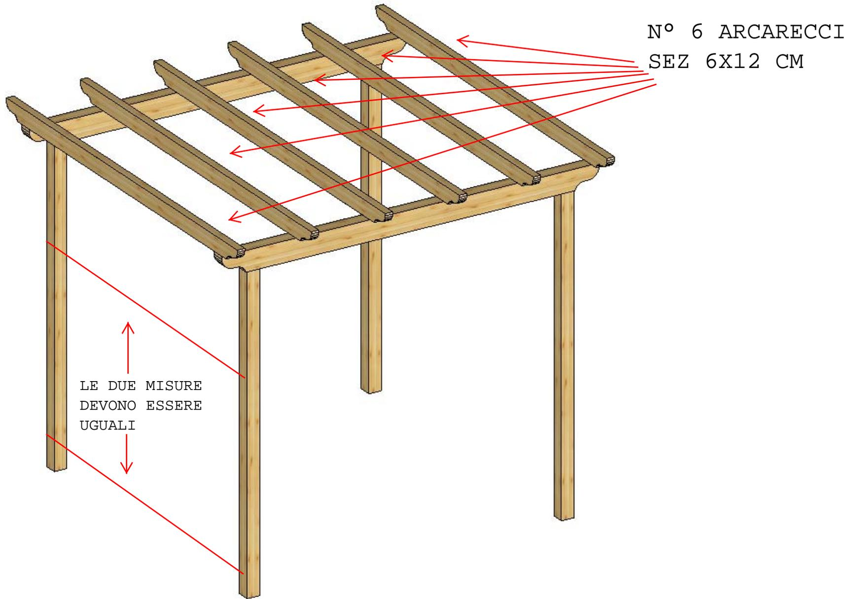
L'ULTIMA FASE DI INSTALLAZIONE E' IL POSIZIONAMENTO ED IL FISSAGGIO DEGLI ARCARECCI SEZ. 60 X 120 MM. VERIFICARE NUOVAMENTE CHE LA DISTANZA ALLA BASE ED ALLA SOMMITA' DEI PILASTRI SIA UGUALE. PROCEDERE POSIZIONANDO GLI ARCARECCI SEZ. 60 X 120 MM SUI TRAVI DI BANCHINA IL PRIMO E L'ULTIMO DEVONO ESSERE A FILO DEI TRAVI DI BANCHINA VEDERE PAGINA SEGUENTE.
