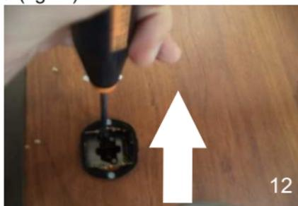
Posizionare un cacciavite nel foro entrata chiave (fig 12) spingere leggermente verso l'alto fino a quando il cilindro si infila senza forzare. (fig 13)
