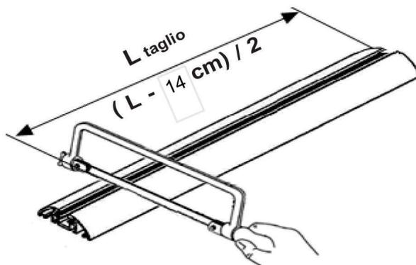
\* Le guide inferiori e superiori saranno unite al centro da appositi blocchetti di giunzione forniti in dotazione.
