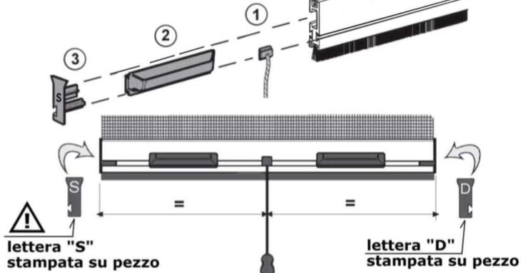
**6 Premontare i controtappi C con le molle M sul cassetto (fig.A) ed inserirlo nel vano finestra (fig.B)**
