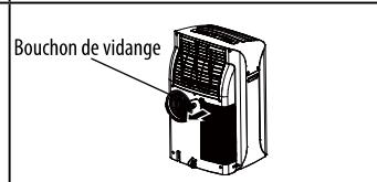
3. Reliez le tuyau en PVC à la sortie de drainage.
