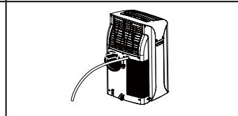
Il dispositivo di arresto e un esemento che serve a impedire che il tubo rientri eccessivamente nell'apparecchio.
