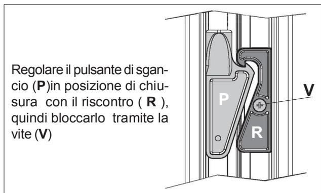
Regolare il pulsante di sgancio (P) in posizione di chiusura con il riscontro (R), quindi bloccarlo tramite la vite (V)
